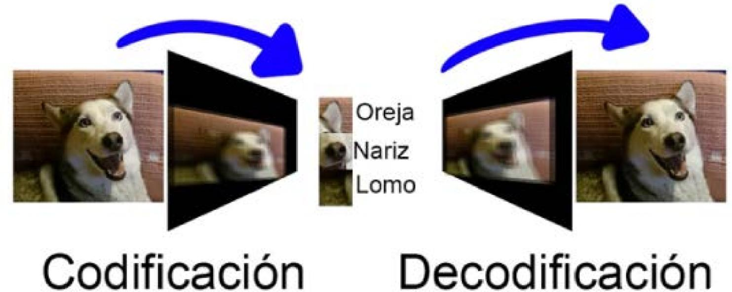
**Figura 11** Este diagrama pretende ejemplificar, de una forma muy simple, lo que los VAEs hacen: durante la fase de entrenamiento se ajustan los parámetros de la red neural de tal forma que el VAE pueda reconstruir la imagen original. Adaptada de “Neural discrete representation learning”, (Van Den Oord et al., 2017)
