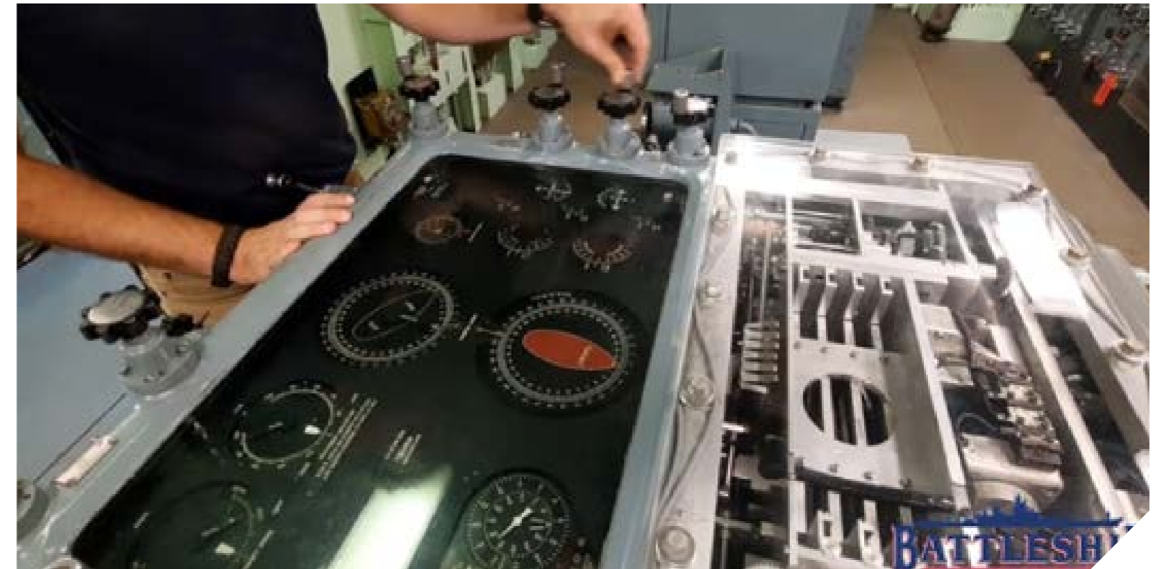
Figura 1 Computadora de control de fuego de la USS New Jersey. Obsérvense las manivelas para introducir información sobre el buque y sobre su objetivo. Tomada de “Fire Control” en YouTube (Battleship New Jersey, 2020)
